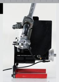
將化油器的彎管,改為向後傾斜(約與側板同角度)。
