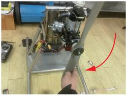
7. 將螺旋槳轉離開壓縮位置(馬達啟動會較省力),啟 動開關讓燃油進入化油器內後停止。
