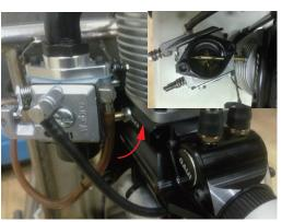
8. 阻風門開啟,螺旋槳轉離開壓縮位置後將CDI電源開啟即可發動引擎。
