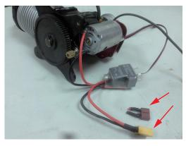
將開關的主電源線一組接到馬達,另一組接至電池 (視插頭規格是否相同做更換)。兩組電源線沒有輸 入、輸出之分。
