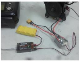
2. 將開關的訊號線接到接收機,送上遙控器電源做啟 動及關閉的訊號測試,此時不需接上主電源的電池。
