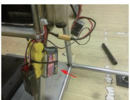
5. 接上主電源做啟動測試,主電源電池以3S容量須大於800mAh。
